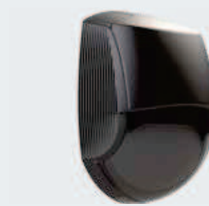
3D laserski skener Scanprotect Kontrola polja sa sedam ukoso nameštenih laserskih zraka prema principu merenja protoka svetlosti, individualne mogućnosti procenjivanja, naročito pogodno za spoljnu upotrebu, vrsta zaštite kućišta IP 65
