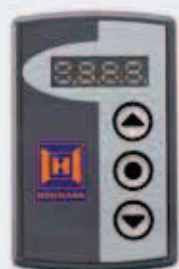
Eksterni upravljački element za FUE-1 za jednostavnu upotrebu i programiranje, može se postaviti nezavisno od upravljačke kutije, isti tasteri kao kod upravljačke kutije kao i četvorostruki sedmostegmentni displej
